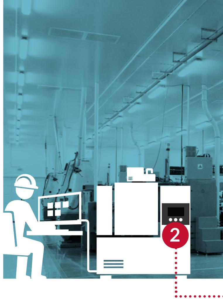
**SinLog** si compone dei dispositivi **SinBox Edge (1)** o **SinBox View (2)** per la raccolta di informazioni dalle macchine di produzione; di un **SinBox Server (3)** per l'elaborazione e l'archiviazione dei dati e della **Web App (4)** di gestione.
